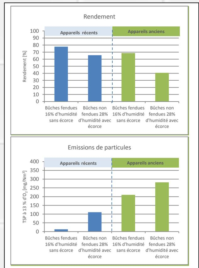
Figure 1- Exemples de résultats obtenus sur les différents essais en conditions équivalentes (tirage naturel et réglage nominal de combustion)
