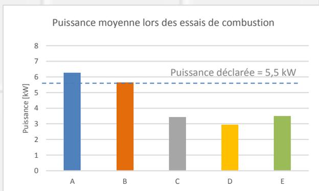
L'efficacité de l'appareil était visiblement dégradée avec les combustibles les plus humides. L'impact pour le consommateur se traduit, pour un besoin de chauffage identique, par **une consommation beaucoup plus importante de combustible (jusqu'à 50% de plus)**. Les écarts de puissance observés montrent aussi un confort dégradé avec les combustibles humides et de gros calibre. **Les combustibles humides ne chauffent tout simplement pas ou peu.**
